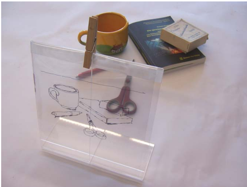
Umfunktionalisierung eines Tischaufstellers aus Plexiglas zur Zeichenmaschine
