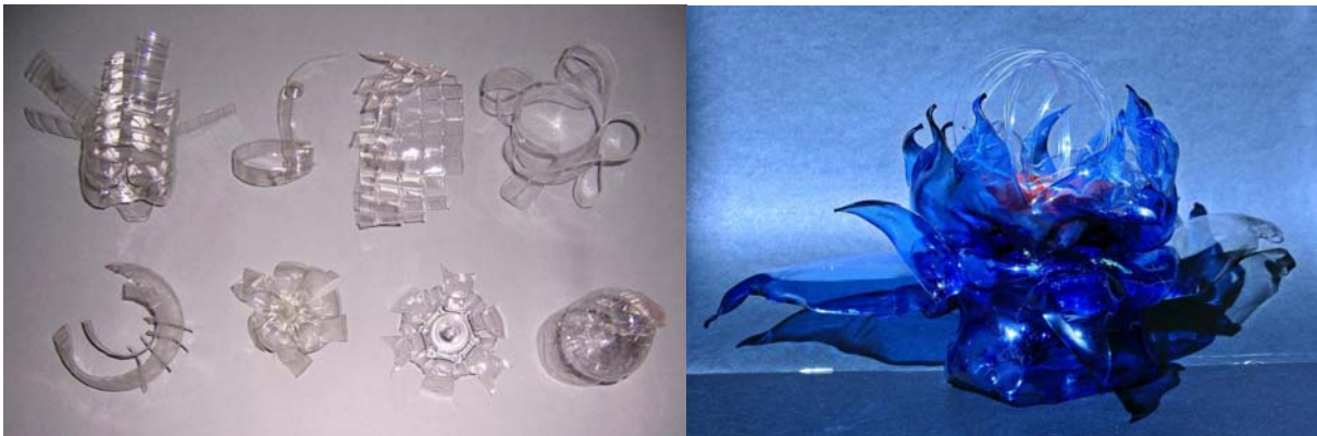
Abb. 9) Werkstoffuntersuchung von PET-Flaschen und Übertragung der Materialerfahrung in eine funktionale Gestaltung
